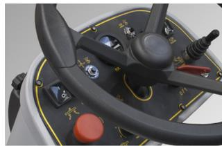
Facile à utiliser grâce à des commandes simples et intuitives. À partir du panneau de commande, l'opérateur peut régler la vitesse maximale d'avancement et la quantité de solution de nettoyage, en sélectionnant l'option la mieux adaptée au type de saleté. Le travail est simplifié et accéléré par le levage automatique de la raclette et de la plaque de brosses.
