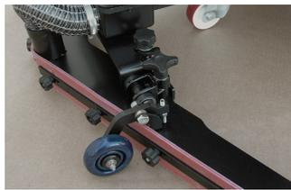
La raclette robuste en V en profilé d'acier réglable permet de combiner le fonctionnement des lames en caoutchouc avec la puissance d'aspiration élevée, pour obtenir un résultat de séchage parfait sur toutes les surfaces. Le filtre spécifique retient les impuretés et empêche l'obstruction du tuyau d'aspiration.
